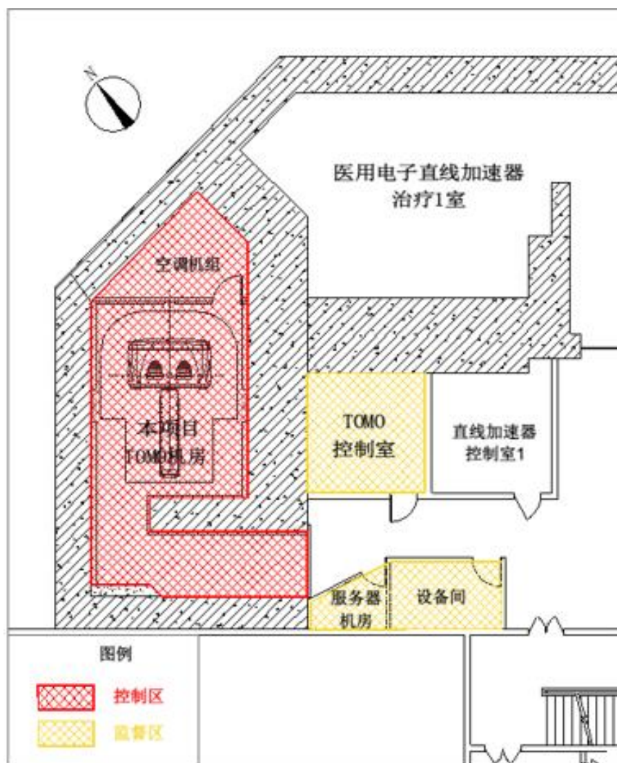
图 10-1 TOMO 机房分区示意图
